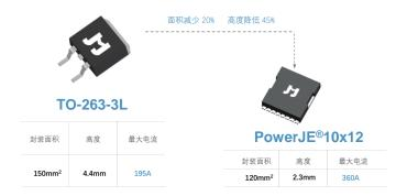
因应客户对性能及 BOM (bill of material) 空间的需求日渐提升,捷捷微电同时推出 N 沟道含自主知识产权 JSFET® 系列的 JMSH1001ATL ( $V_{DS,Max} = 100V$ ) 和 JMSH1504ATL ( $V_{DS,Max} = 150V$ ) , 两者均采用先进 PowerJE®10x12 封装。在  $V_{GS} = 10V$  条件下,器件的  $R_{DS(ON),Typ}$  及 FOM 测量值分别是  $1.3m\Omega$  / 202 (JMSH1001ATL) 及  $3.3m\Omega$  / 290 (JMSH1504ATL) 。其中 JMSH1001ATL 的电气特性,更为国内领先水平、与欧美日同类产品不遑多让。此外,一流的线性模式 / 安全工作区 (SOA) 特性,使器件在大电流的工作状态下,仍能实现安全可靠的运作。极低的导通电阻有助于提高运行效能,降低系统成本,并延长器件的使用寿命。这两款产品已经广泛应用于电动工具、轻型电动车辆、光伏储能逆变器、5G 通信及 PoE++ 等终端。
